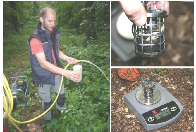
Prélèvement d'échantillons d'eau pour analyse de leur concentration en éléments chimiques majeurs et mesure in situ du taux de dissolution
